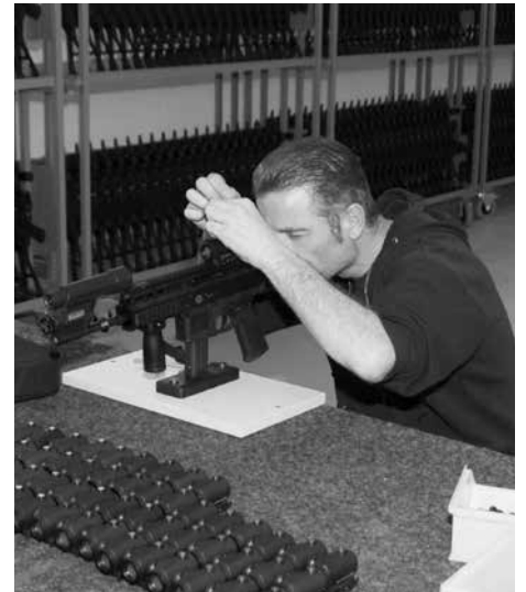
Ajustage du viseur d'un carabinier de fabrication B&T AG.
