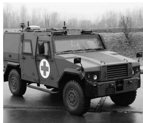
Deutschland schützt seine Soldaten der ISAF-Mission in Afghanistan u.a. mit Schweizer Fahrzeugen. Im Bild: ein geschütztes Fahrzeug EAGLE in der Ambulanzvariante der Firma GDELS-Mowag GmbH.
