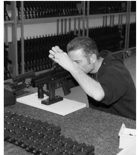
Justierung der Zieloptik eines Polizeikarabiners in der Fertigung von B&T AG.
