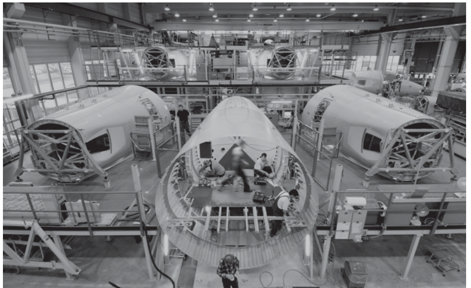
Die Schweizer Industrie stellt Güter für den zivilen und militärischen Gebrauch her und ist auf Absatzmärkte im Ausland angewiesen. Im Bild der Bau von Rumpfteilen für den Airbus A320 bei der RUAG. © RUAG
